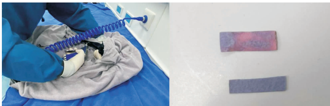
注:左图为操作现场,右图为测试结果,上方试纸代表干燥不合格,下方试纸代表干燥合格。
